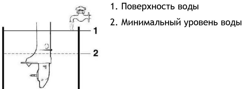
5. Заполните тест-танк пресной водой выше уровня противокавитационной пластины.
