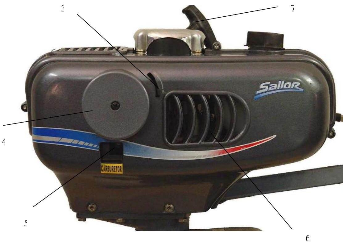
Рис.2-3. 1.Кнопка СТОП. 2.Фиксатор ручки управления. 3.Рычаг управления заслонкой карбюратора. 4.Воздушный фильтр. 5.Насос подкачки топлива. 6.Воздухозаборник. 7.Стартовый трос
