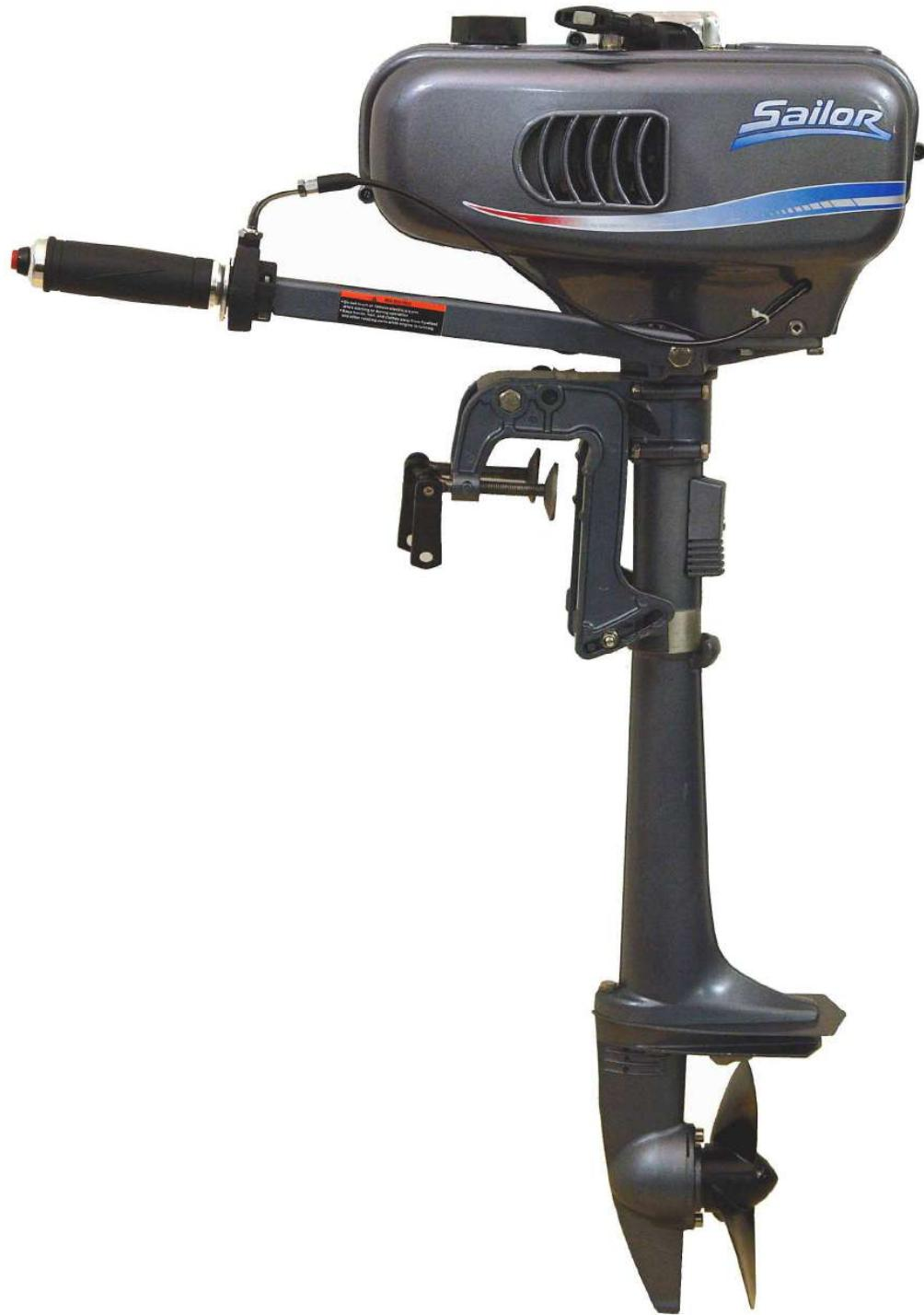
Для движения лодки задним ходом необходимо развернуть мотор на 180° вокруг вертикальной оси и перекинув ручку управления на 180° начать движение. При движении задним ходом не включайте большие обороты мотора, так как лодка имеет плохую управляемость и неустойчива.
