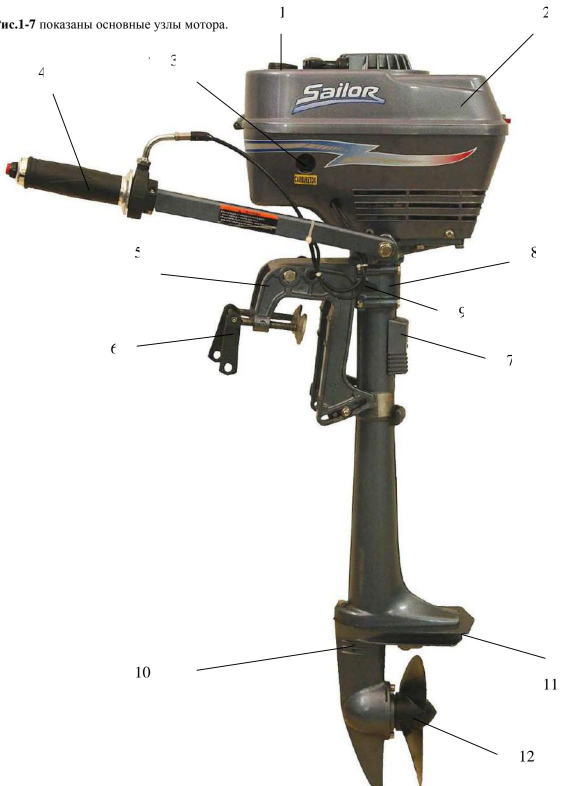
**Рис.1.** 1.Крышка топливного бака. 2.Защитный кожух мотора. 3.Насос подкачки топлива. 4.Ручка управления. 5.Скоба крепления к транцу. 6.Зажимы транцевые. 7.Крышка глушителя. 8.Поворотный шарнир. 9.Фиксатор. 10.Водозаборный канал. 11.Антикавитационная пластина. 12.Гребной винт.
