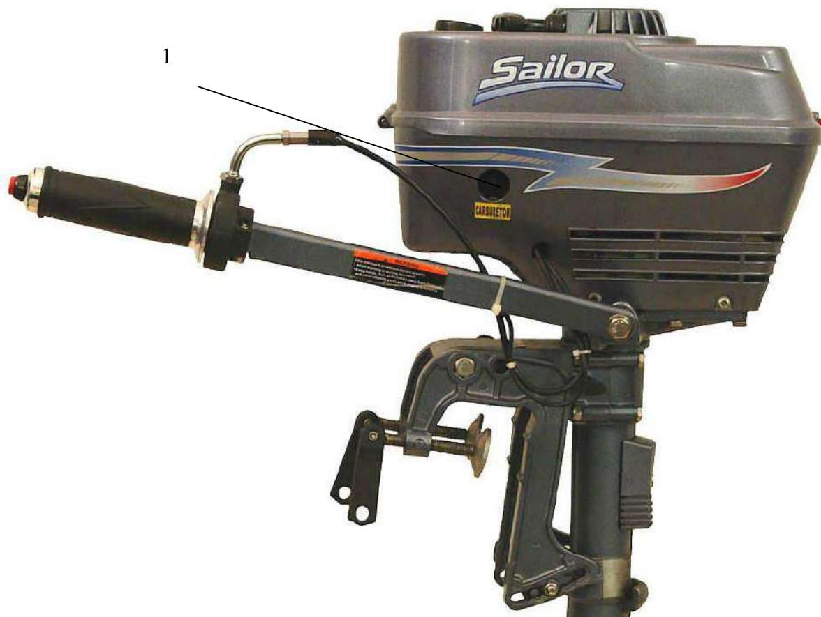
Рис.7. 1.Кнопка подкачки топлива
