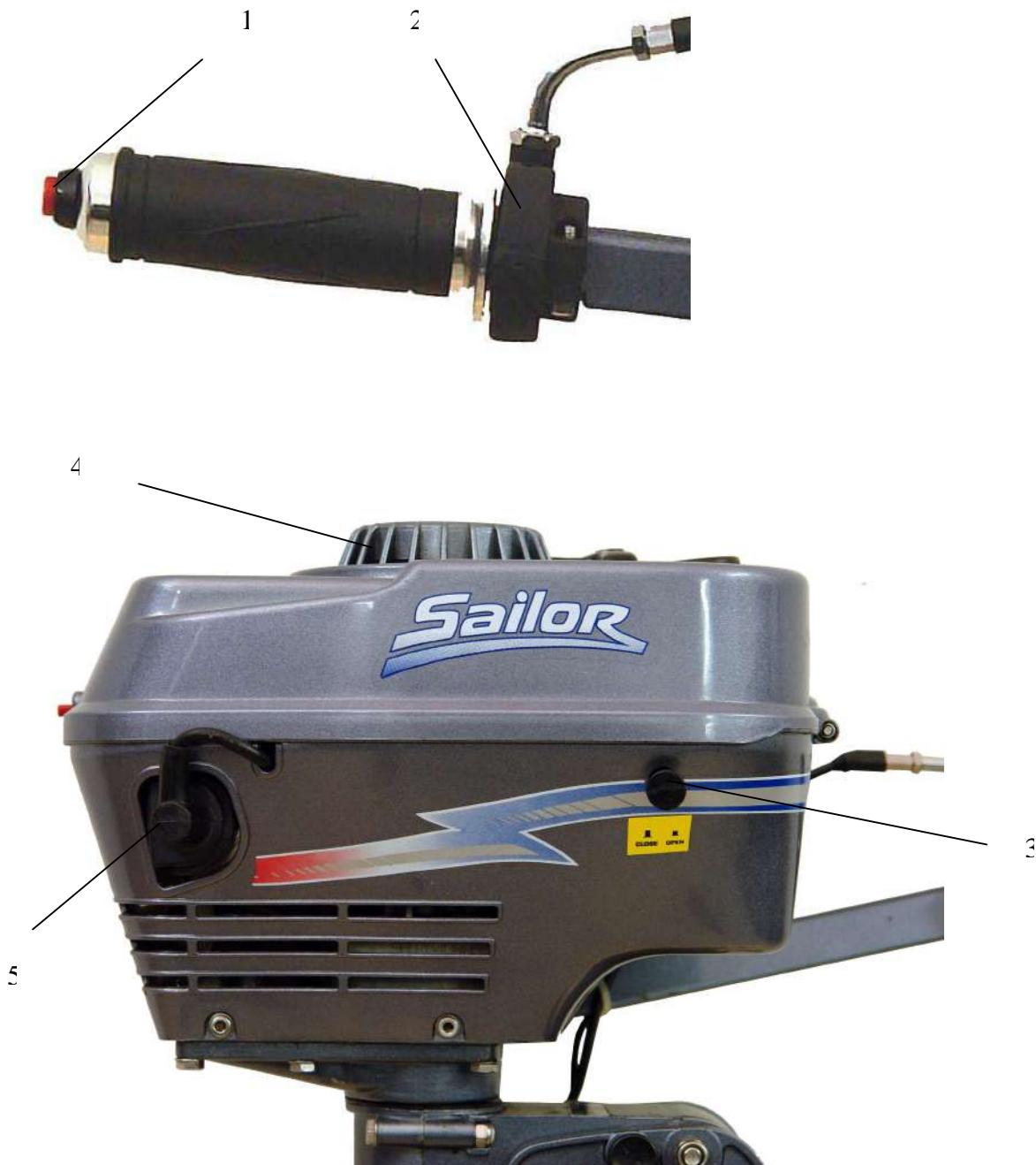
Рис.2-3. 1.Кнопка СТОП. 2.Фиксатор ручки управления. 3.Рычаг управления заслонкой карбюратора. 4.Кожух стартового шнура. 5.Наконечник свечи.
