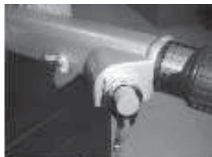
4. Выдвиньте воздушный клапан до упора. После запуска двигателя верните клапан в исходное положение.
