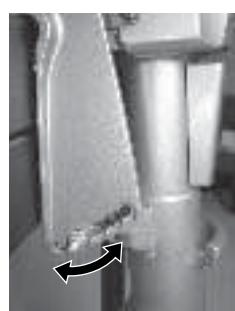
Механизм стопора наклона предотвращает сдвиг мотора от тяги винта при движении назад. Чтобы закрепить механизм, переместите ручку в положение “LOCK”, чтобы освободить мотор – в позицию “TILT”
