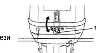
После установки капота на место, проверьте правильно ли легли резиновые уплотнения и закройте защёлку вниз.
