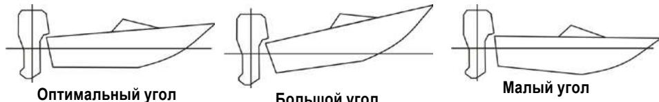
При малом угле дифферента лодка слишком глубоко «сидит» в воде. Из-за этого увеличивается сопротивление ходу, нагрузка на двигатель, расход бензина. Уменьшается скорость передвижения лодки
