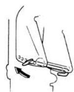
Подбирая оптимальный угол дифферента, изменяйте положение штифта на одно отверстие за раз, проверяйте устойчивость лодки при маневрировании и на волне.
