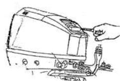
6. После запуска двигателя плавно верните ручной стартер в исходное состояние.
