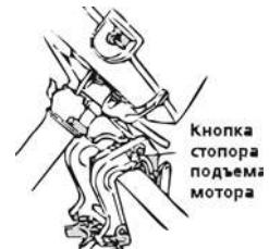
Чтобы опустить двигатель вниз слегка наклоните его внутрь лодки, отведите стопор и медленно опускайте мотор.
