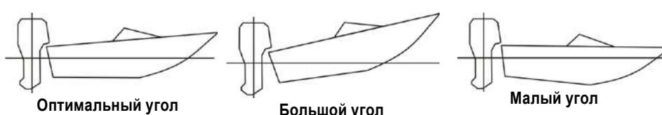
**Для регулировки угла дифферента:**
