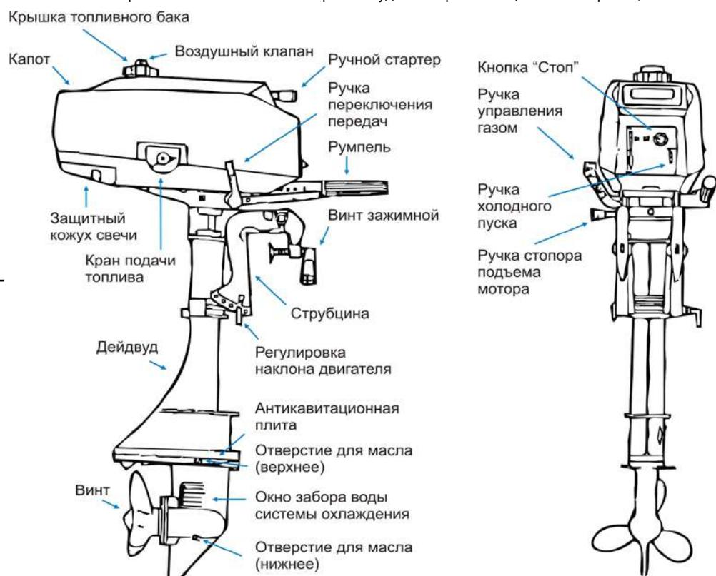
Топливный бак модели HD-2.5F HD-3.5F - встроенный, имеет ёмкость 1,4 л.
