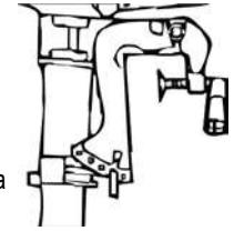
**Транспортное положение двигателя на лодке**
