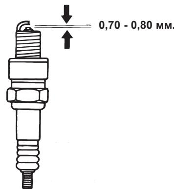
5. При помощи щупа измерьте межэлектродный зазор.
