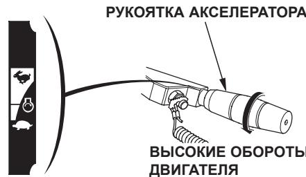
Обороты двигателя регулируются поворотом рукоятки по или против часовой стрелки. При повороте рукоятки в направлении показанной на рисунке стрелки обороты двигателя увеличиваются.
