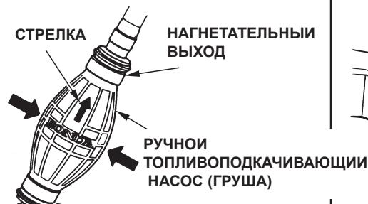
**ВСАСЫВАЮЩАЯ СТОРОНА РУЧНОГО ТОПЛИВОПОДКАЧИВАЮЩЕГО НАСОСА**
