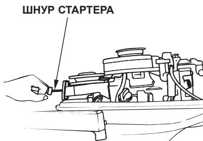
3. Выверните свечу зажигания. Снимите чеку с аварийного выключателя двигателя и несколько раз потяните шнур стартера, чтобы полностью удалить воду из цилиндров.
