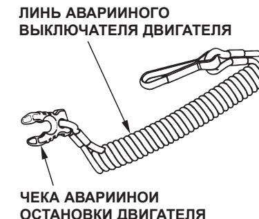
Линь аварийного выключателя двигателя предназначен для экстренного глушения двигателя при падении судоводителя за борт или в случае потери равновесия, когда теряется возможность управления подвесным мотором.
