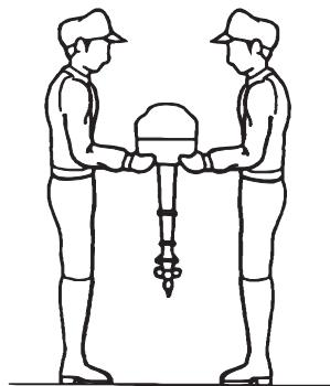
Переносите подвесной мотор вдвоём. При переноске удерживайте двигатель за ручку или за ручку и выступ под замком верхнего кожуха двигателя, как показано на рисунке.
