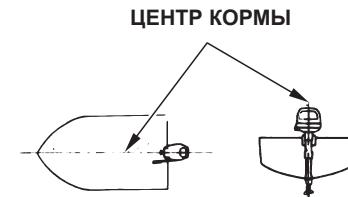
Установите подвесной мотор на корме в диаметральной плоскости лодки.
