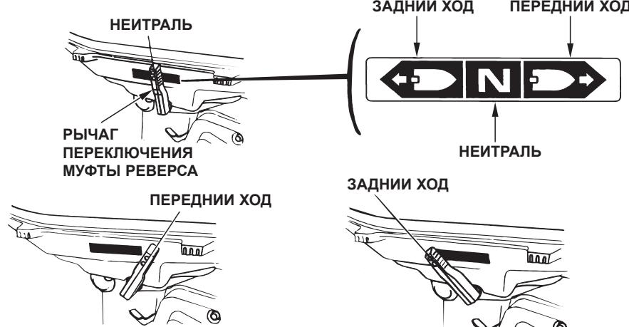
Рычаг переключения муфты реверса предназначен для включения переднего или заднего хода, а также для отключения двигателя от гребного винта. Предусмотрено три фиксируемых положения рычага. Запуск двигателя возможен только если рычаг переключения муфты реверса находится в положении NEUTRAL.
