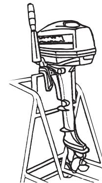
2. Установите рычаг переключения муфты реверса в положение ЗАДНИЙ ХОД (REVERSE).
