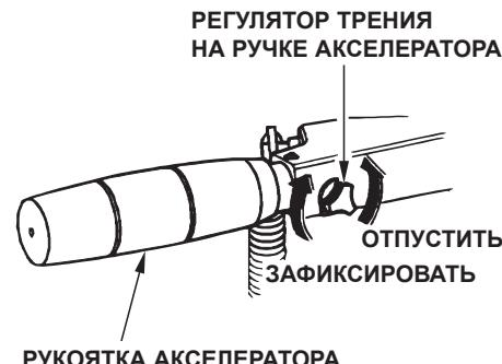
Маховикочек предназначен для регулирования сопротивления вращению рукоятки акселератора. Для закрепления положения рукоятки акселератора при движении с постоянной скоростью нужно повернуть маховикочек по часовой стрелке. Для облегчения вращения рукоятки акселератора поверните маховикочек против часовой стрелки.
