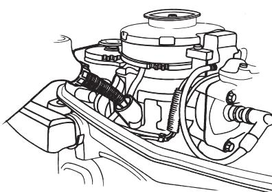
3. Залейте рекомендуемое масло в двигатель до верхней отметки на щупе. Наденьте крышку маслоналивной горловины, не наворачивая её, снимите и проверьте уровень масла.
