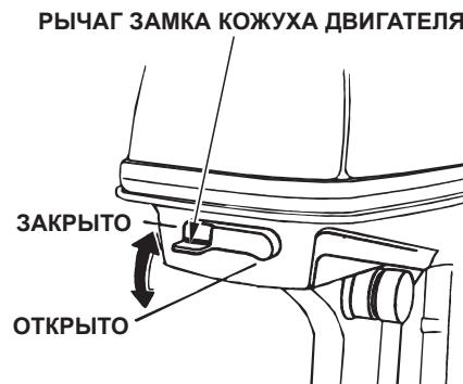
Для того чтобы снять капот двигателя или закрепить его после установки, соответственно, поднимите рычаг фиксатора и отведите запорную скобу или установите скобу и опустите рычаг фиксатора.
