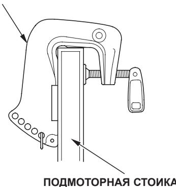
1. Закрепите струбцины на подмоторной стойке и установите мотор на струбцинах.
