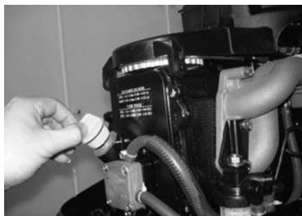
3) Установите новую прокладку на сливной болт. Нанесите тонкий слой масла на прокладку и установите сливной болт на место.
