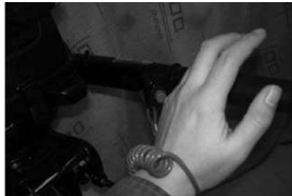
Надёжно закрепите трос аварийного выключателя зажигания за одежду, за руку или за ногу. Затем установите блокирующую пластинку с другого конца троса на аварийный выключатель зажигания.
