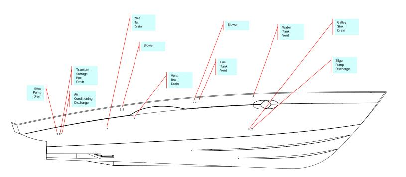
35 MOTOR YACHT THRU HULLS STARBOARD
