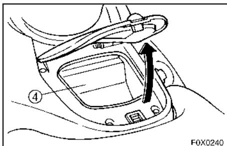
Перчаточный ящик :Вместимость : 2 литра (0,53 галлона США, 0,44 галлона Великобритании)Предельная загрузка: 1 кг (2,2 фунта).
