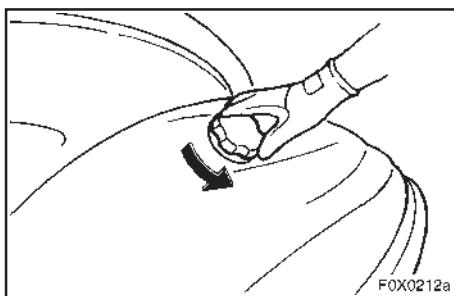
**ПРИМЕЧАНИЕ:** Перед тем как запустить двигатель спущенного на воду гидроцикла, снимите крышку наливной горловины топливного бака и сбросьте давление, которое может образоваться в топливном баке.
