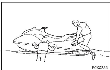
**ПРИМЕЧАНИЕ:** Чем больше суммарная масса водителя и пассажира, тем труднее сохранять равновесие гидроцикла. Не управляйте судном, общая нагрузка которого превышает 160 кг (353 фунта), включая любой груз. Если Вам трудно сохранять устойчивость гидроцикла, поступайте следующим образом:
