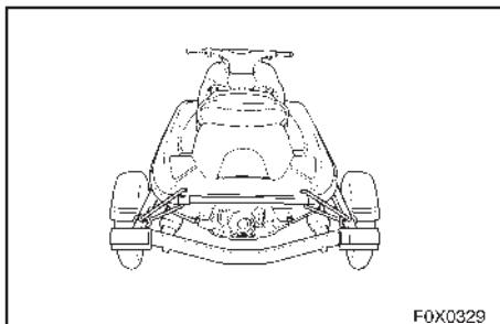
При перевозке гидроцикла на прицепе, надежно закрепите его, пропустив тросы через носовую проушину и через кормовые отверстия для троса.
