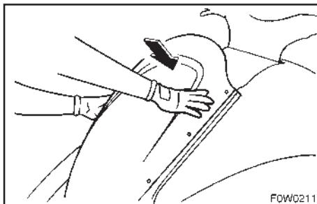
Для того, чтобы закрыть переднее багажное отделение, нажмите на заднюю часть капота так, чтобы он надежно защелкнулся.
