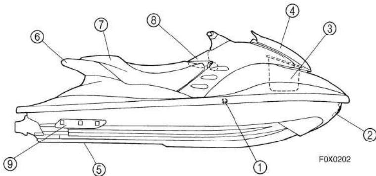
**① Контрольное отверстие для выхода охлаждающей воды**
