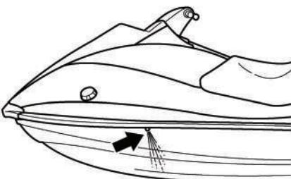
Для проверки работы охлаждающей системы проследите, выбрасывается ли вода через выходное отверстие. Если вода не выбрасывается, может оказаться, что в двигателе не циркулирует охлаждающая вода. В такой ситуации необходимо остановить двигатель и установить причину. (См. дополнительную информацию на страницах 33 и 78.)
