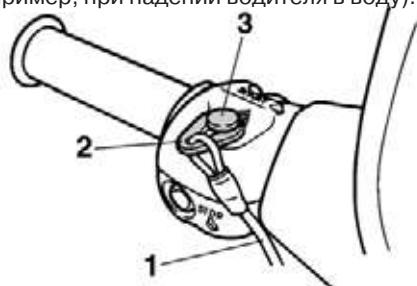
1 Линь аварийного выключателя двигателя
