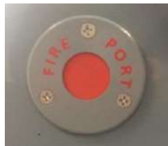
Feuerlöschöffnung auf der Backbordseite der Konsole
