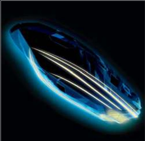
尖舦滑水艇船体，尾部船底斜度可变（飞桥和阿特兰蒂斯系列） Hard-chine planing hull with variable deadrise (Flybridge and Atlantis Collections)
