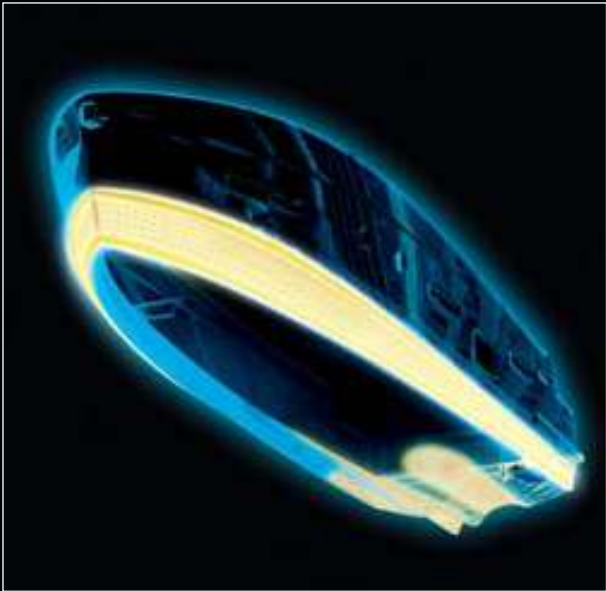
双模式半滑水艇船体，侧推器管道、艉鳍和直立型艏（麦哲伦系列） Dual Mode semi-planing hull with tunnel, skeg and vertical bow (Magellano Collection)
